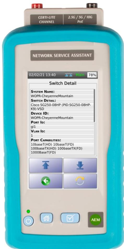
ケーブルテスト機器は、検証、認定（検証とも呼ばれる）、および認証のカテゴリに長い間分類されてきました。請負業者は、設置後にメーカーのケーブル保証を取得するために、認証テスターが必要です。ただし、請負業者がケーブルプラントを建物の所有者に引き渡した後は、ネットワークマネージャーの責任で、実際のネットワーク接続を認定し、アプリケーションを深く掘り下げて、一貫したネットワーク稼働時間を確保します。企業ではスマートビルディングのネットワーク接続テクノロジーへの依存度が高まっているため、IT部門は現在、銀行を壊すことなくネットワークの資格と認証のカテゴリ間のギャップを埋めるケーブルテストツールを必要としています。
