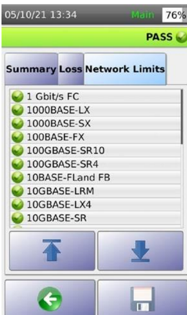
図3-ネットワーク規格は、テスト結果に基づいてケーブルでサポート可能なすべてのネットワークを報告します
