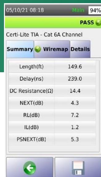
図4-Certi-Liteオートテストの結果は、リモートIDで取得できます。[詳細]タブをクリックすると、各テスト結果が表示されます。テスト結果は、付属のPCベースのTestDataProに後でアップロードするために、または有線または無線ネットワーク接続を介して付属のTestDataProクラウドですぐにテストメモリに保存できます。
