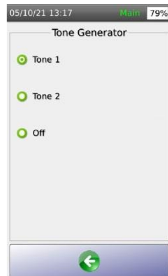
図6-トーンセネレーションオプションは、フィルタリングトンプローブが受信するさまざまなトーンオプションを提供します。
