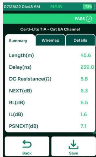
図4-Certi-Liteオートテストの結果は、リモートIDで取得 できます。[詳細]タブをクリックすると、各テスト結果が表示されます。テスト結果は、付属のPCベースの TestDataPro に後でアップロードするために、または有線または無線ネットワーク接続を介して付属の TestDataPro クラウドですぐにテスターメモリに保存できます。
